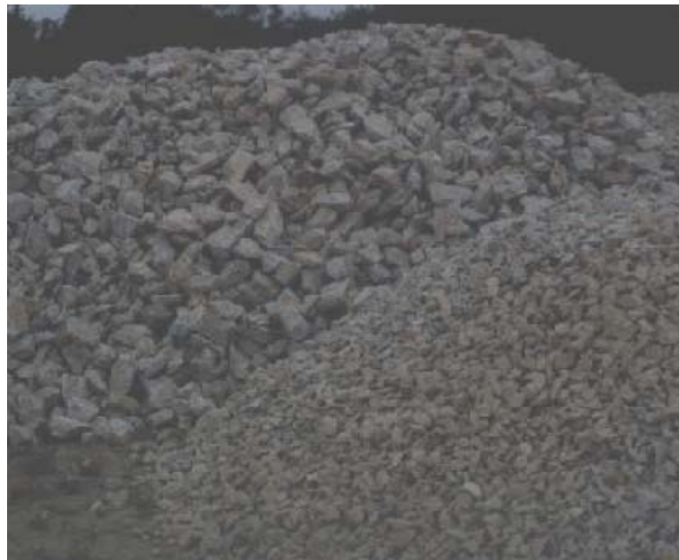
Figura 30. Detalle de trozos de caliza de 30/150 mm de diámetro y una pureza del 93,45%.
