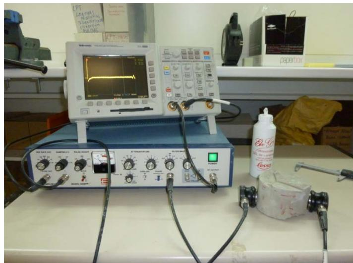
Figura 68. Osciloscopio digital y equipo usado para el cálculo de la velocidad de propagación del sonido.
