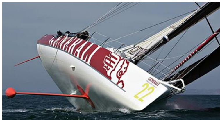
Figura 2-1. Embarcación a vela con doble quilla.
