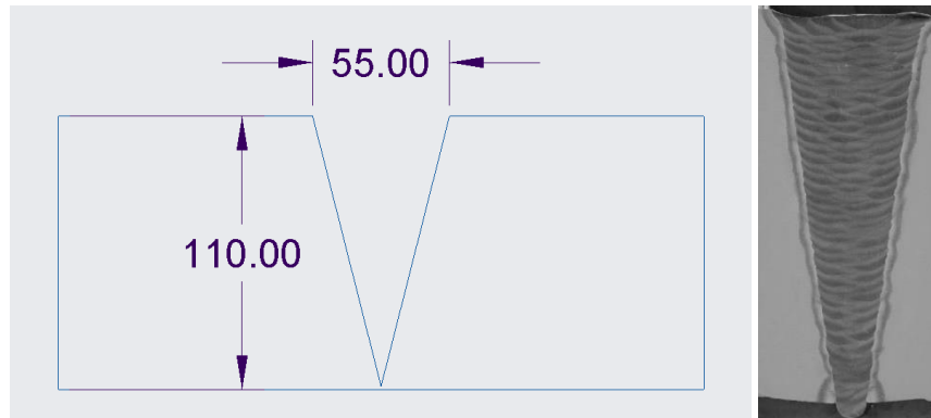
Figura 4-2. Diseño de la junta de unión soldada
