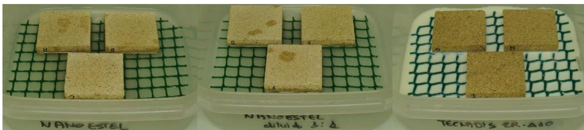
Figura 16. Consolidación de las probetas destinadas a permeabilidad. A la izquierda las probetas A, B y C con Nano Estel puro; en el centro las probetas D, E y F con Nano Estel diluido 1:1; y a la derecha las probetas G, H e I con Tecnadis ZR-110.
