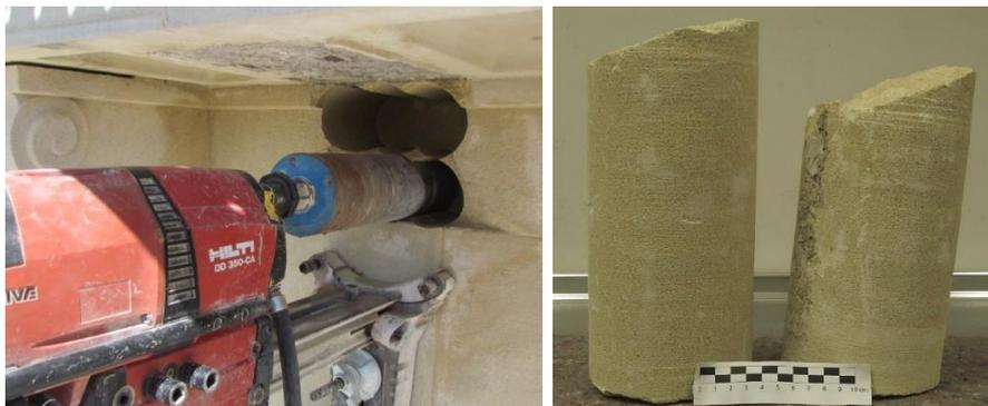
Figura 2. A la izquierda la extracción de los cilindros con la testificadora. A la derecha dos de los cilindros de piedra de Novelda.
