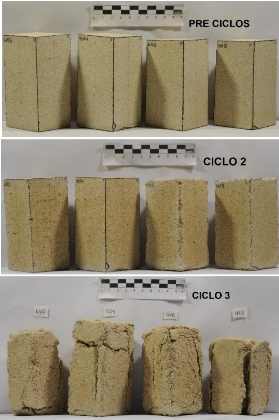
Figura 55. Vista lateral: caras x e y de las probetas NV2 (Nano Estel puro), NV4 (Nano Estel diluido 1:1), NV6 (Tecnadis ZR-110) y NV8 (Blanco) para el ensayo de cristalización de sales.
