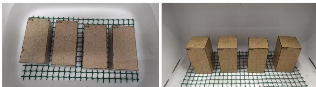
Figura 19. A la izquierda las probetas en inmersión en agua y a la derecha en congelador a -23°C.
