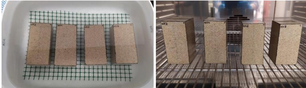
Figura 18. A la izquierda las probetas en inmersión en la solución salina y a la derecha en estufa a 105°C.
