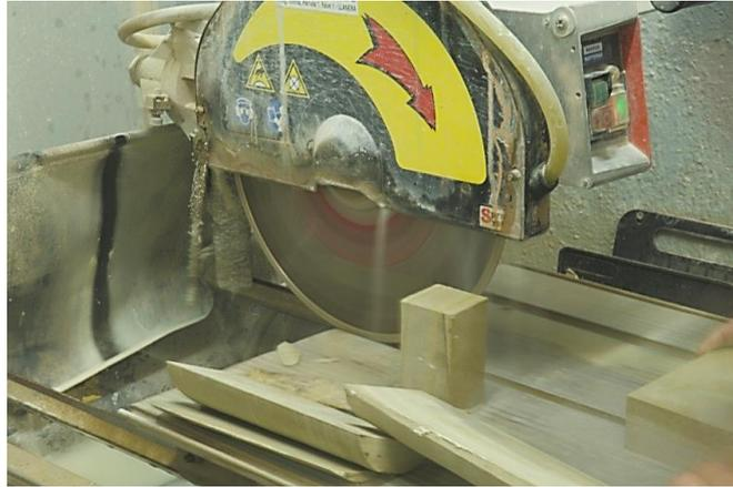
Figura 3. Proceso de corte de las probetas mediante sierra de corte con disco diamantado.
