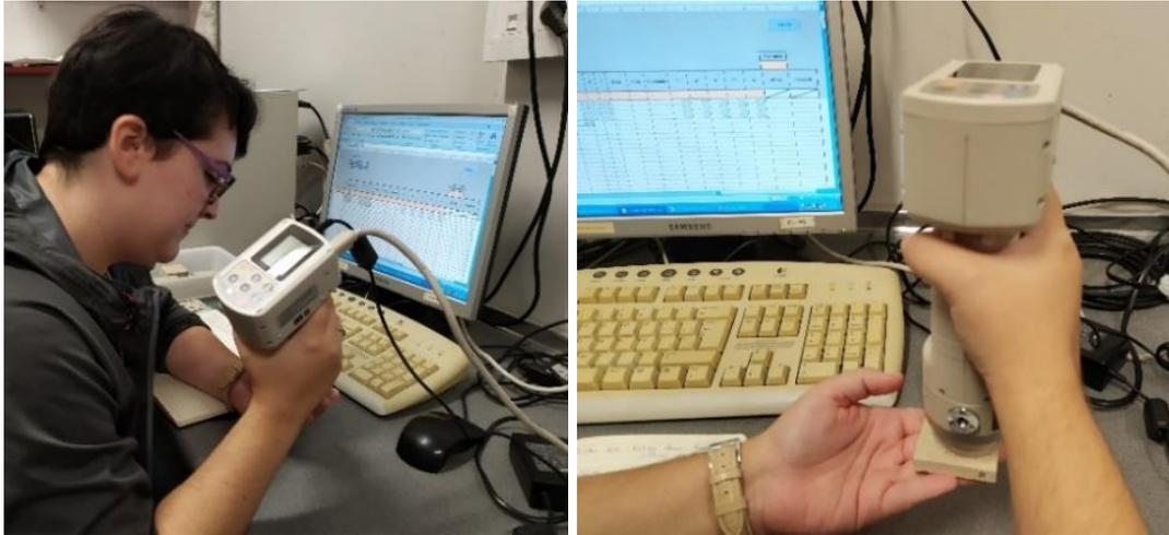
Figura 6. Medición del color mediante el colorímetro Chroma Meter CR-400/410.
