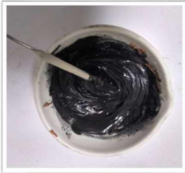
Figura 8. Mezcla homogeneizada de silicona líquida y magnetita
