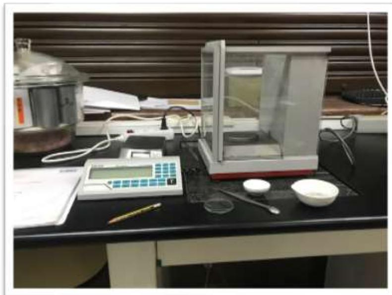
Figura 7. Báscula de precisión y otros utensilios utilizados para realizar la mezcla.
