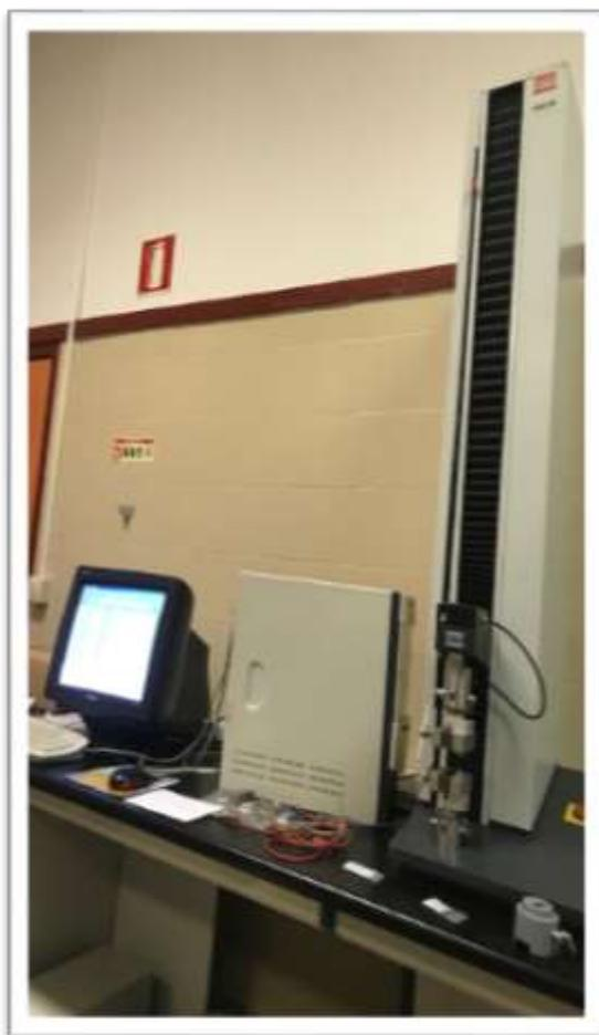
Figura 15. Máquina de tracción conectada al PC
