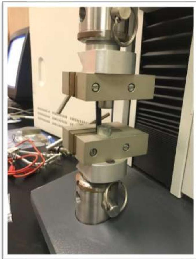
Figura 14: Ensayo de tracción de una probeta de silicona.
