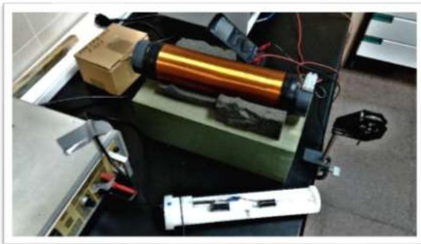
Figura 12. Instalación para la medida del efecto Villari.
