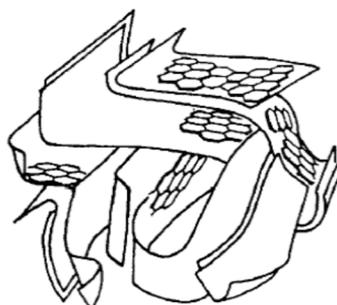
**Figura 3.1** Representación esquemática típica de la microestructura del carbón activado [67].
