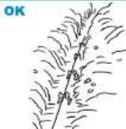
Utilizar soportes colgados de la bandeja para sostener el peso del cable durante el embudo. Usar trocillos para salvar bordes y esquinas, y para disminuir el rozamiento con el terreno en tendidos en zanjas.
