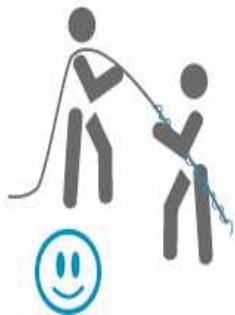
En la fase de enhebrar la camisa de acero trenzado (malla) al cable conductor, se recomienda hacerlo **entre dos trabajadores**, uno frente a otro, manteniendo una posición erguida con los pies ligeramente separados y adelantando cada trabajador una pierna en el sentido del empuje: un trabajador empuja el cable conductor en un sentido, y el otro empuja la camisa de acero en sentido contrario, hasta conseguir enfundar el cable por completo.
