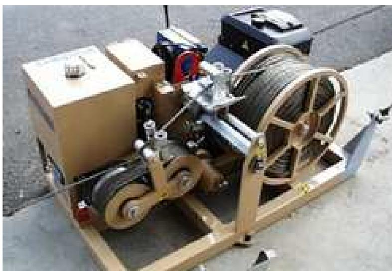
**Figura 33. Cabrestante para el tendido de cable subterráneo**
