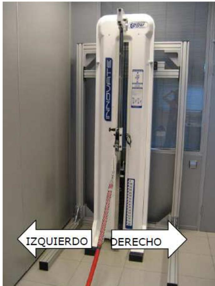
**Figura 6. Banco de pesas estándar para la simulación de la tracción del cable**
