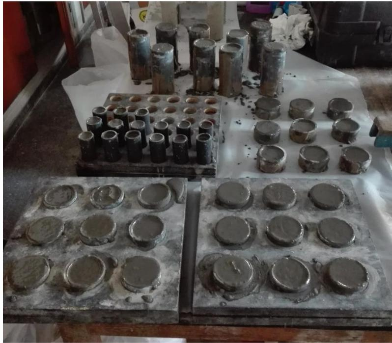
**FIGURA 13. ALGUNAS DE LAS PROBETAS LISTAS PARA FRAGUAR.**
