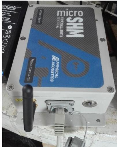
FIGURA 23. TARJETA DE ADQUISICIÓN MICRO-SHM
