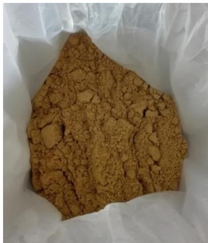
**FIGURA 10. ARENA PREPARADA PARA REALIZAR LA MEZCLA DE MORTERO.**
