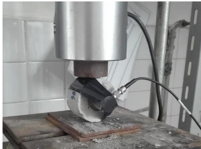
**FIGURA 25. PROBETA TRACCIÓN LISTA PARA ENSAYAR CON SENSOR DE EMISIÓN ACÚSTICA**
