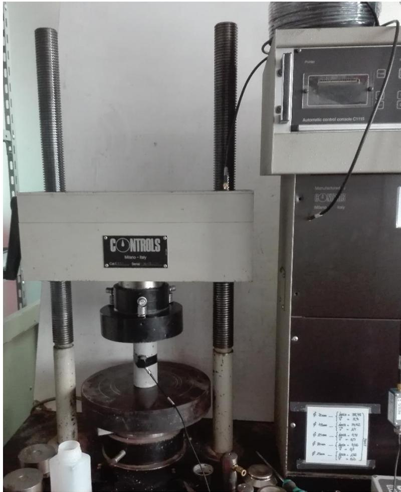
FIGURA 20. PROBETA DE COMPRESIÓN LISTA PARA ENSAYAR
