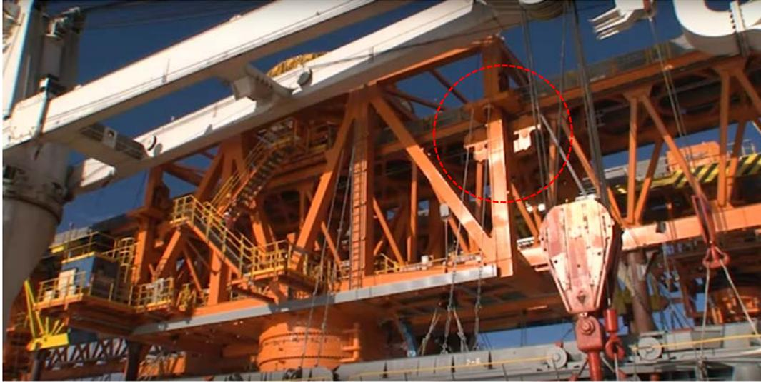
Figura 7.33 - Ruedas de apoyo montadas sobre un bogie en un cargador de barcos [19]
