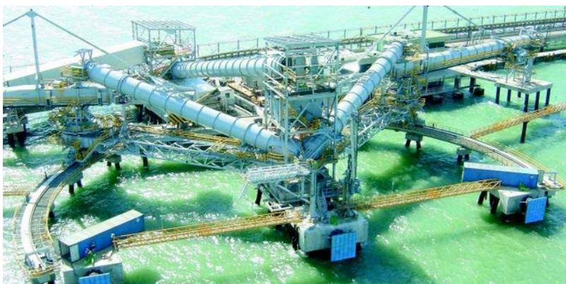
Figura 3.13 - Cargadores de doble giro orbital [9]
