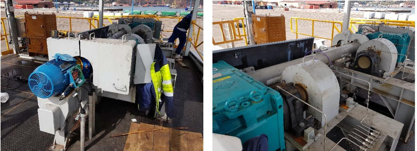
*Figura 9.2 - Accionamientos de traslación acoplados mediante un eje común*
