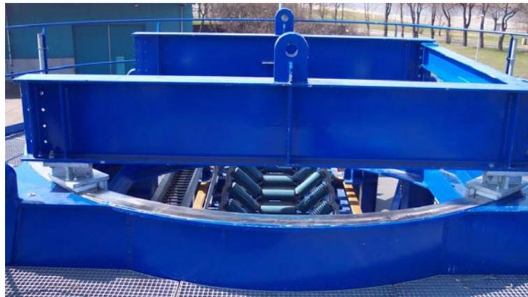
Figura 7.23 - Apoyo de la galería de la cinta transportadora de alimentación sobre el anillo superior del cradle
