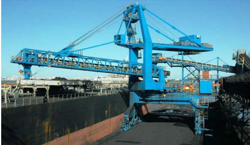
Figura 3.10 - Cargador de traslación [6]
