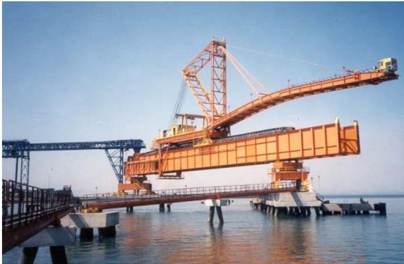
Figura 3.12 - Cargador circular lineal [8]
