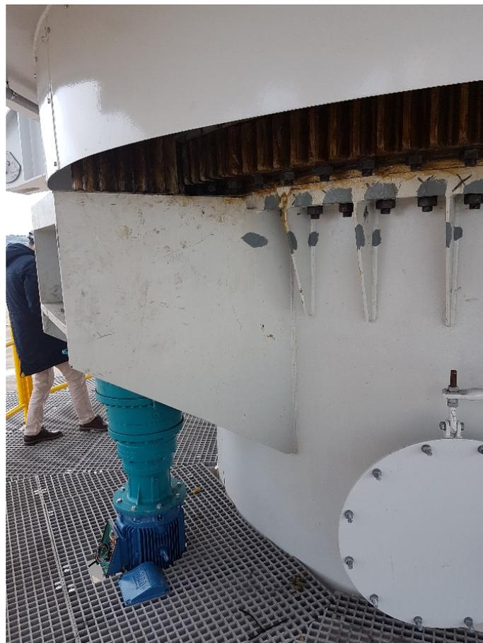
*Figura 9.4 – Mecanismo de giro situado entre los anillos de la base y del cradle*
