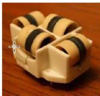
Figura 8. Antenas helicoidales desplegadas y enrolladas en resortes de cintas de fibra de vidrio.
