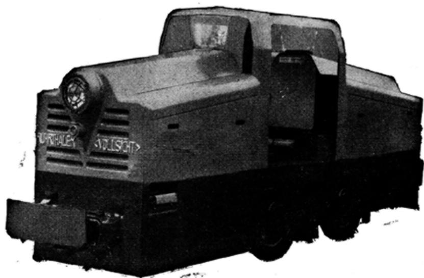
Locomotora Diesel Ruhrthal minera, con plena visibilidad, para servicio interior.
