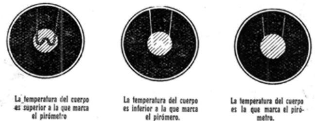
FIGURA 24 Determinación de la temperatura con un pirómetro óptico.
