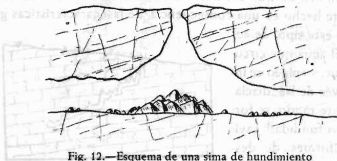
Fig. 12.—Esquema de una sima de hundimiento
