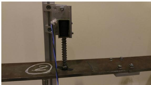
Figura 3: Imagen del actuador acoplado a la bancada.
