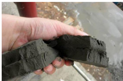
Figura 31: Consistencia de los relaves filtrados (RET, 2007)
