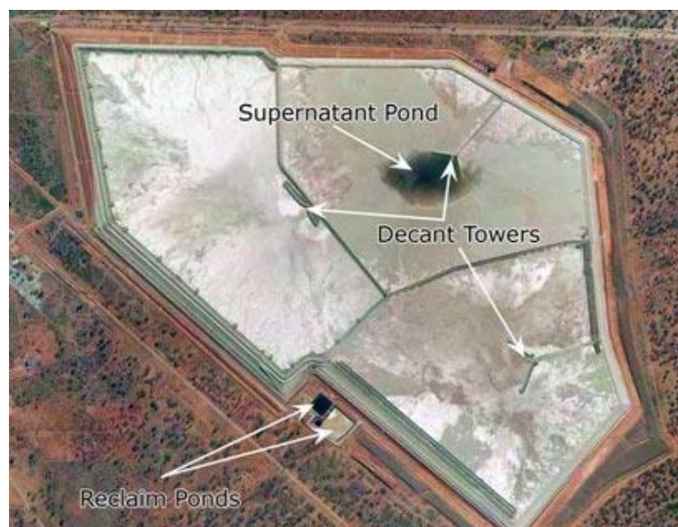
Figura 4: Configuración de dique de anillo (disposición en tres celdas) en Kalgoorlie Consolidated Gold Mines, Australia Occidental
