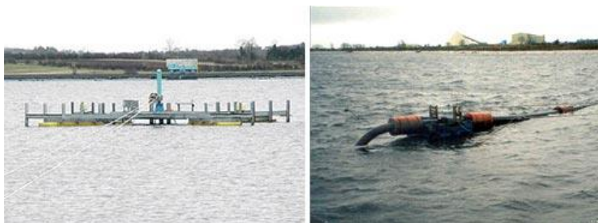
Figura 13: Deposición subacuosa de relaves convencionales (@Jon Engels)
