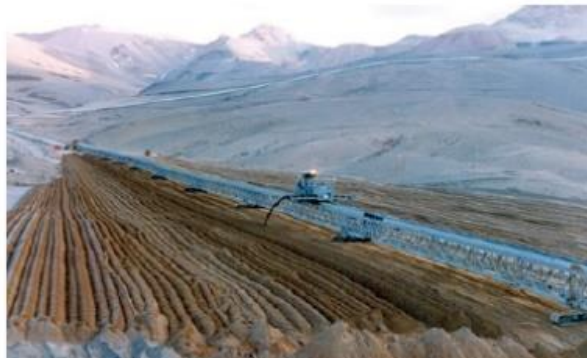
Figura 21: Pilas secas, relaves filtrados transportados mediante cinta transportadora y compactados mediante topadora, (Australian Government, 2016)
