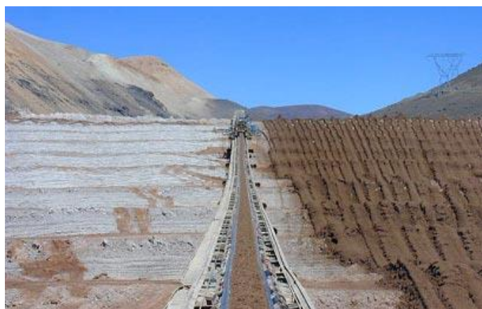
Figura 18: Apilamiento en seco de relaves mediante cinta transportadora en La Coipa, Chile
