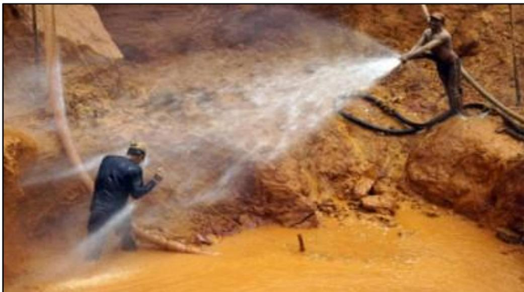
**Figura 13.** Minería hidráulica artesanal.
