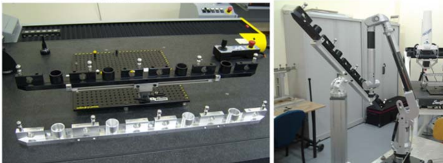
Fig. 1.- Concepto de Patrón de características geométricas. Arriba.- imagen del CAD explicativa de la patente. Abajo.- Prototipos materializados de Aluminio Anodizado y montaje de uno de ellos sobre utillaje para multiposición.
