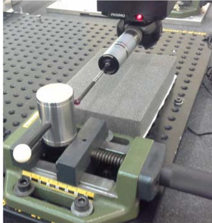
Fig.7.– Primeras pruebas de palpado en continuo (scanning) sobre el sector del cilindro para materialización del perfil de cuasi-envolvente.
