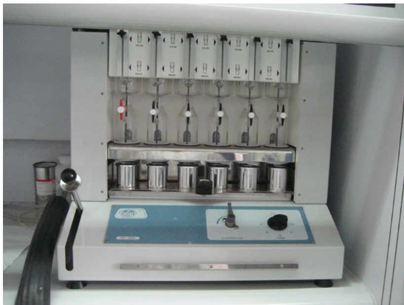
Figura 6. Extractor Soxhlet utilizado para la extracción de grasas de las muestras de queso.
