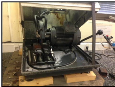
*Figura 5: Tronzadora de disco, marca Buelher, modelo Abrasimet 2.*
