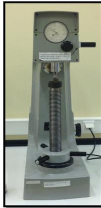
Figura 1: Durómetro Rockwell
