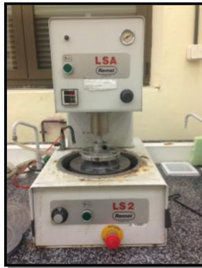
*Figura 7: Pulidora automática marca LSA, modelo Remet.*
