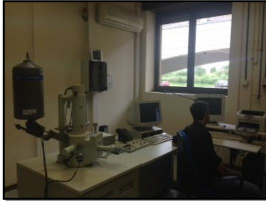
*Figura 8: Microscopio electrónico de barrido modelo JEOL JSM-5600.*
