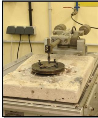
*Figura 3: Tribómetro de la marca Microtest, modelo MT/30/SCM/T.*
