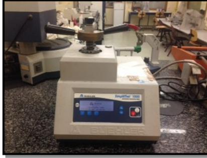
*Figura 6: Embutidora marca Buelher, modelo SimpliMet 1000.*
