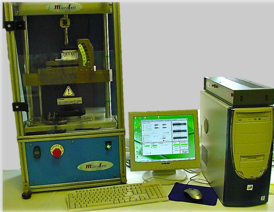
**Figura 15.** Máquina de fluencia de carga preparada para los ensayos
