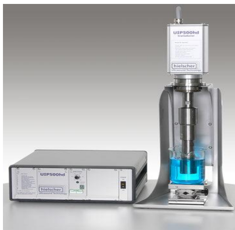
Figura 12. Imagen del instrumento de sonicación utilizado. Sonda de ultrasonidos inmersa en el recipiente de reacción.
