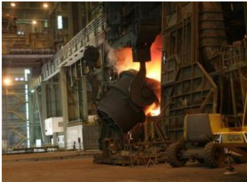
Figura 6. Vertido de arrabio en el convertidor LD en la factoría de Arcelor-Mittal en Tabaza. (López M. , 2014).
