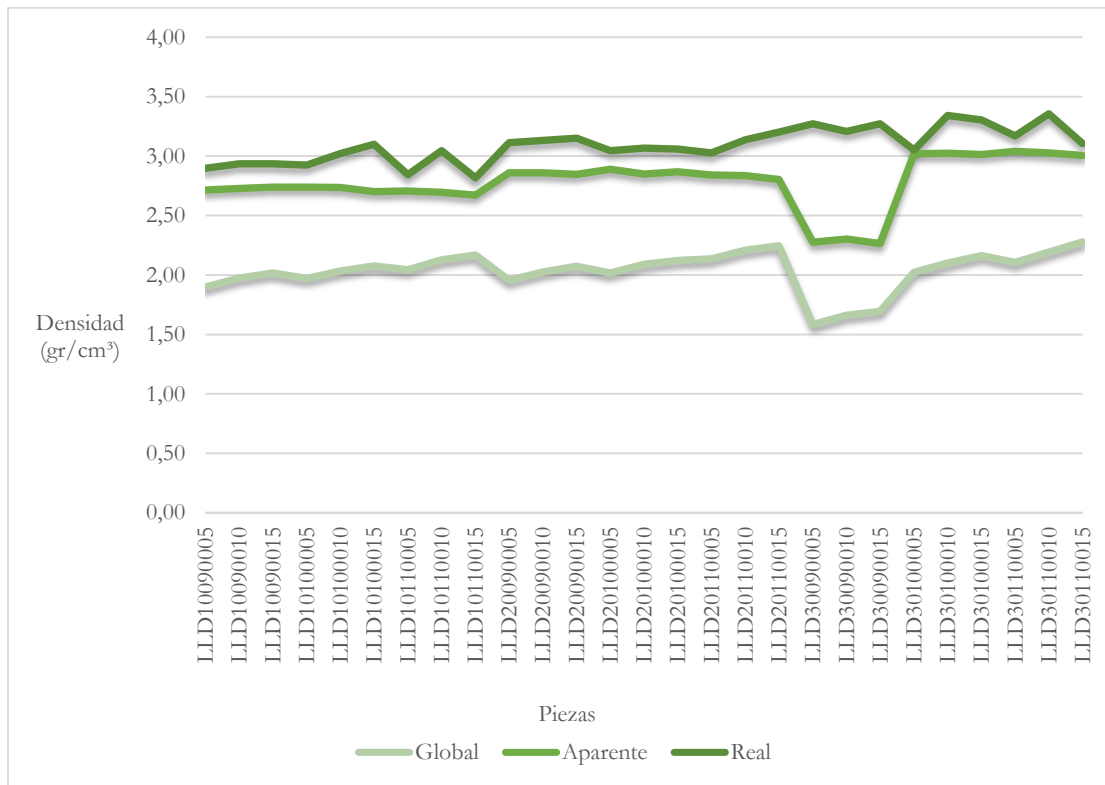
Figura 94. Gráfico comparativo densidades. Piezas LLD.
