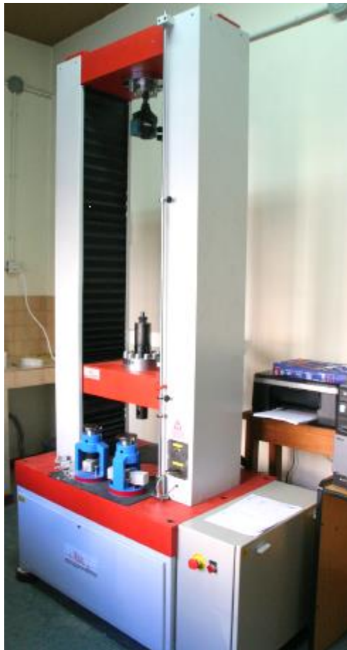
Figura 101. Máquina universal de ensayos mecánicos.
