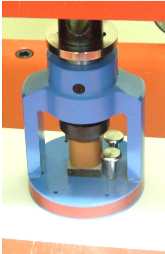
Figura 102. Dispositivo ensayos compresión con pieza cerámica cilíndrica.
