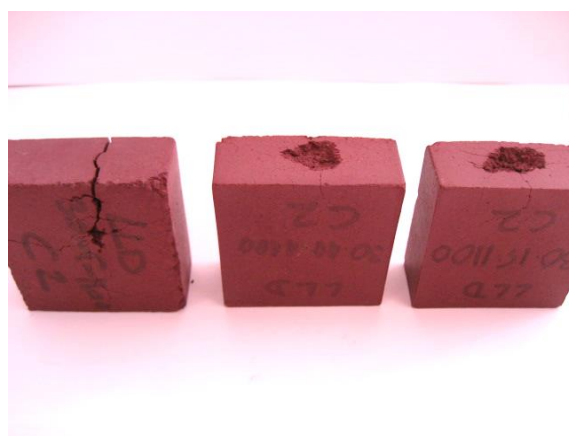
Figura 64. Piezas con el 30% LLD y cocidas a 1100 °C, correspondientes a todas las presiones de conformado después del ensayo de heladicidad.
