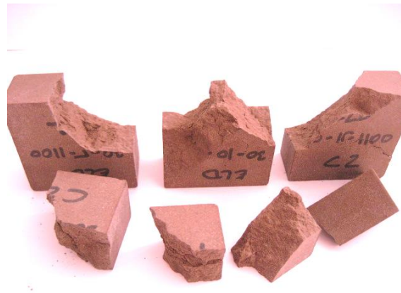
Figura 50. Piezas con el 30% ELD y cocidas a 1100 °C, correspondientes a todas las presiones de conformado después del ensayo de heladicidad.
