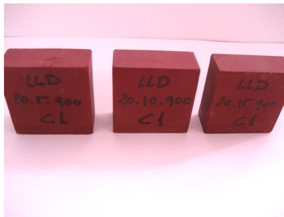
Figura 59. Piezas con el 20% LLD y cocidas a 900 °C, correspondientes a todas las presiones de conformado después del ensayo de heladicidad.
