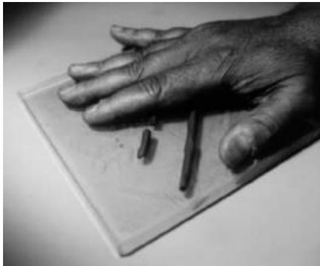
Figura 8. Ensayo para determinar el límite plástico de la arcilla o mezcla arcillosa (Das, 2001).
