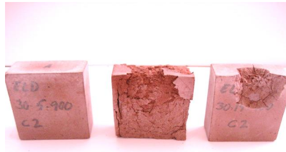
Figura 47. Piezas con el 20% ELD y cocidas a 1100 °C, correspondientes a todas las presiones de conformado después del ensayo de heladicidad.
