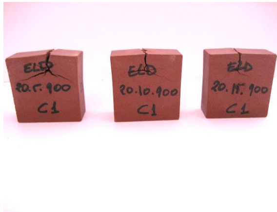
Figura 45. Piezas con el 20% ELD y cocidas a 900 °C, correspondientes a todas las presiones de conformado después del ensayo de beladicidad.
