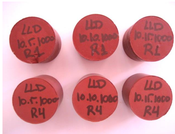
Figura 82. Piezas con el 10% LLD y cocidas a 1000 °C, en la parte superior, correspondientes a todas las presiones de conformado después del ensayo de eflorescencias y en la fila inferior piezas patrón.
