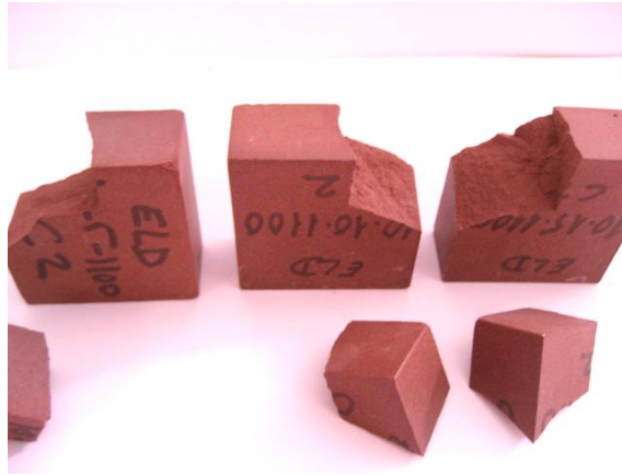
Figura 44. Piezas con el 10% ELD y cocidas a 1100 °C, correspondientes a todas las presiones de conformado después del ensayo de beladicidad.
