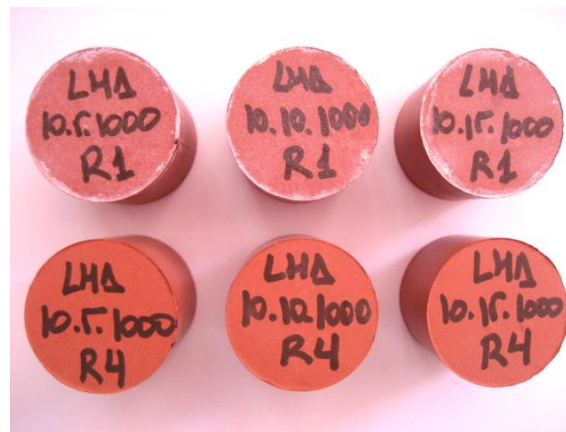
Figura 78. Piezas con el 10% LHA y cocidas a 1000 °C, en la parte superior, correspondientes a todas las presiones de conformado después del ensayo de eflorescencias y en la fila inferior piezas patrón.
