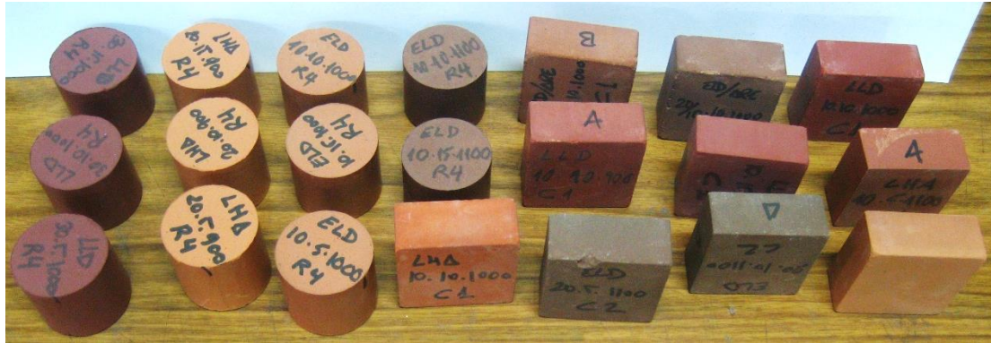
Figura 36. Aspecto de algunas piezas cerámicas después de cocción.
