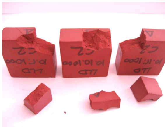
Figura 57. Piezas con el 10% LLD y cocidas a 1000 °C, correspondientes a todas las presiones de conformado después del ensayo de heladicidad.
