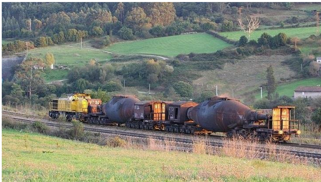
Figura 5. Tren con vagones torpedero perteneciente a Arcelor-Mittal. (Trigos, 2014).
