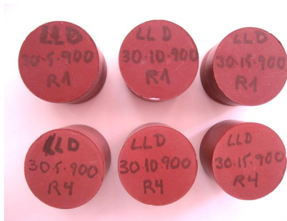
Figura 87. Piezas con el 30% LLD y cocidas a 900 °C, en la parte superior, correspondientes a todas las presiones de conformado después del ensayo de eflorescencias y en la fila inferior piezas patrón.
