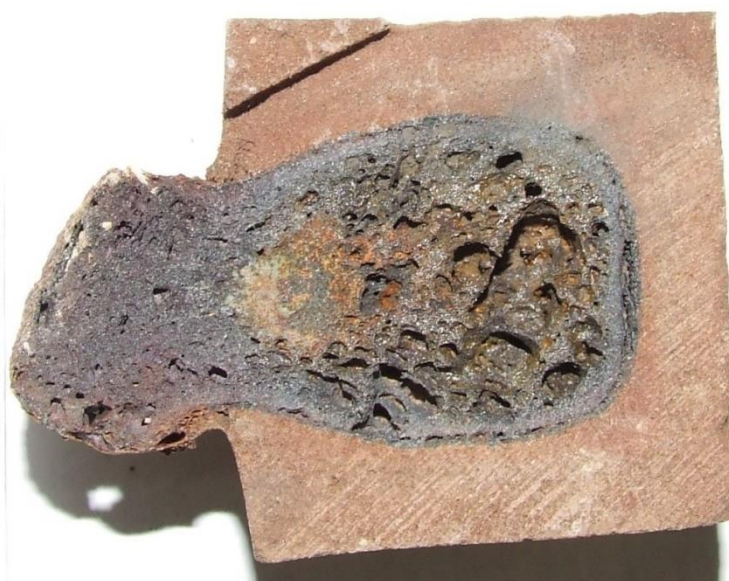
Figura 41. Detalle corazón negro en una pieza cilíndrica LHA.
