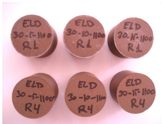
Figura 76. Piezas con el 30% ELD y cocidas a 1100 °C, en la parte superior, correspondientes a todas las presiones de conformado después del ensayo de eflorescencias y en la fila inferior piezas patrón.
