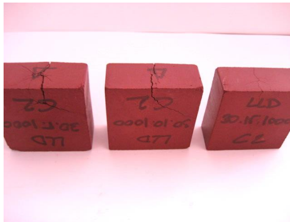
Figura 63. Piezas con el 30% LLD y cocidas a 1000 °C, correspondientes a todas las presiones de conformado después del ensayo de beladicidad.
