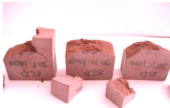
Figura 48. Piezas con el 30% ELD y cocidas a 900 °C, correspondientes a todas las presiones de conformado después del ensayo de heladicidad.
