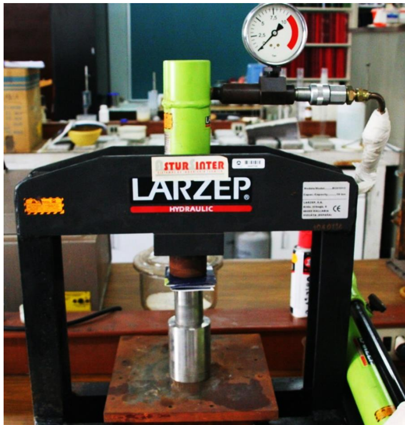
Figura 31. Prensa hidráulica utilizada en laboratorio para el conformado de las piezas.
