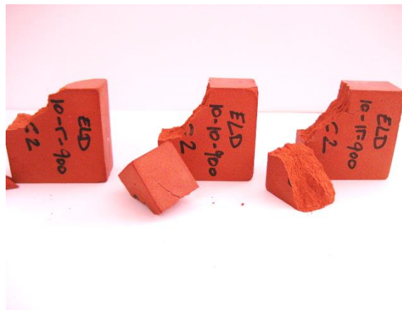
Figura 42. Piezas con el 10% ELD y cocidas a 900 °C, correspondientes a todas las presiones de conformado después del ensayo de heladicidad.
