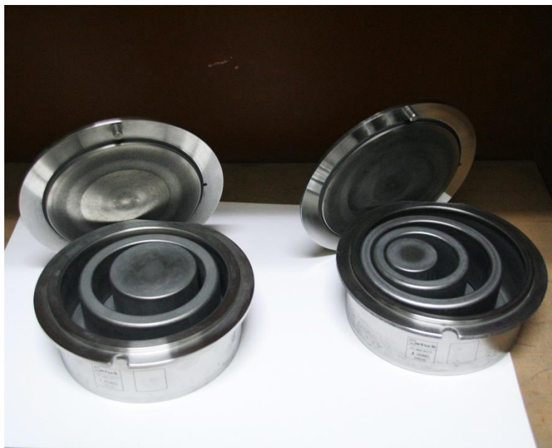
Figura 30. Detalle muelas de disco y cámara de molienda.
