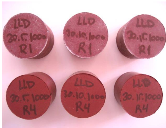
Figura 88. Piezas con el 30% LLD y cocidas a 1000 °C, en la parte superior, correspondientes a todas las presiones de conformado después del ensayo de eflorescencias y en la fila inferior piezas patrón.
