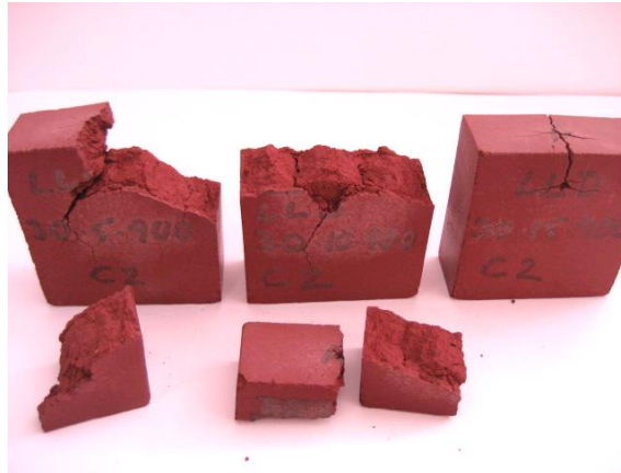
Figura 62. Piezas con el 30% LLD y cocidas a 900 °C, correspondientes a todas las presiones de conformado después del ensayo de beladicidad.
