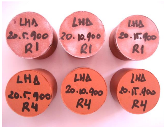
Figura 79. Piezas con el 20% LHA y cocidas a 900 °C, en la parte superior, correspondientes a todas las presiones de conformado después del ensayo de eflorescencias y en la fila inferior piezas patrón.
