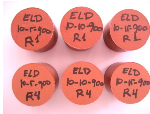
Figura 68. Piezas con el 10% ELD y cocidas a 900 °C en la parte superior, correspondientes a todas las presiones de conformado después del ensayo de eflorescencias y en la fila inferior piezas patrón.
