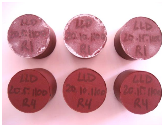
Figura 86. Piezas con el 20% LLD y cocidas a 1100 °C, en la parte superior, correspondientes a todas las presiones de conformado después del ensayo de eflorescencias y en la fila inferior piezas patrón.
