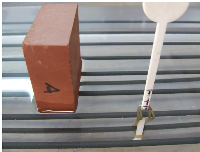
Figura 65. Pieza cerámica en el ensayo de capilaridad.
