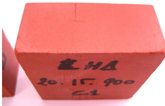
Figura 54. Detalle de la rotura. Grieta en la parte superior. Pieza LHA2090015.
