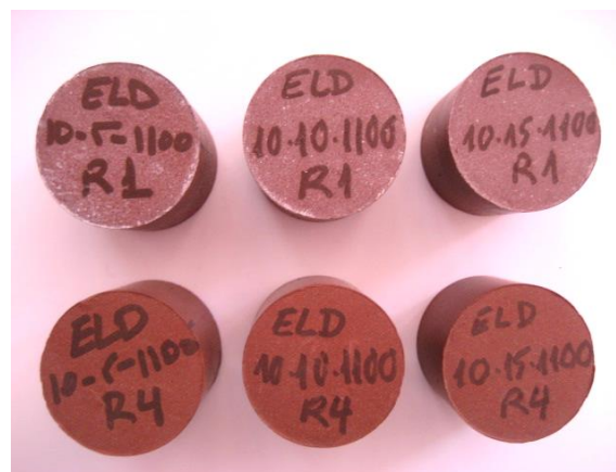
Figura 70. Piezas con el 10% ELD y cocidas a 1100 °C, en la parte superior, correspondientes a todas las presiones de conformado después del ensayo de eflorescencias y en la fila inferior piezas patrón.
