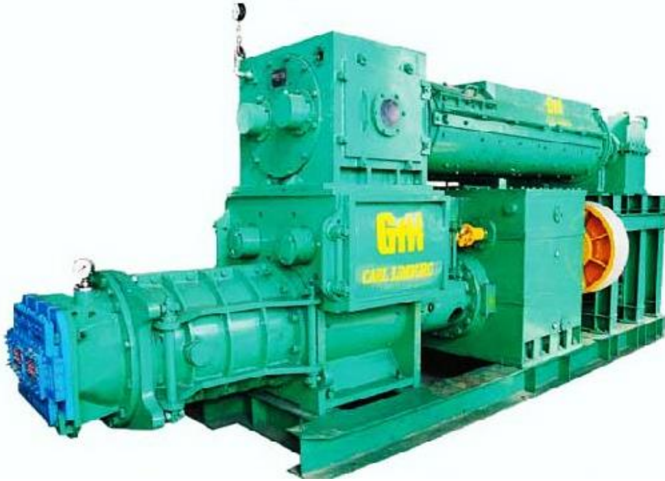
Figura 26. Extrusora GFK para la producción de ladrillos/bloques.
