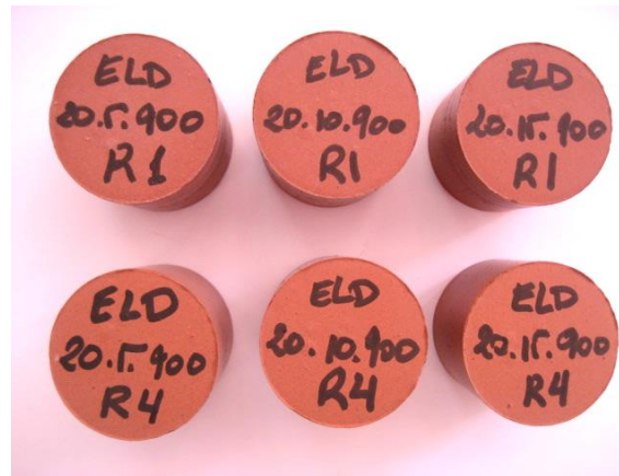
Figura 71. Piezas con el 20% ELD y cocidas a 900 °C, en la parte superior, correspondientes a todas las presiones de conformado después del ensayo de eflorescencias y en la fila inferior piezas patrón.
