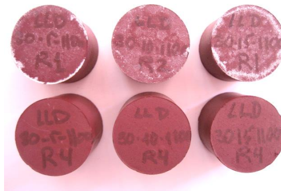
Figura 89. Piezas con el 30% LLD y cocidas a 1100 °C, en la parte superior, correspondientes a todas las presiones de conformado después del ensayo de eflorescencias y en la fila inferior piezas patrón.
