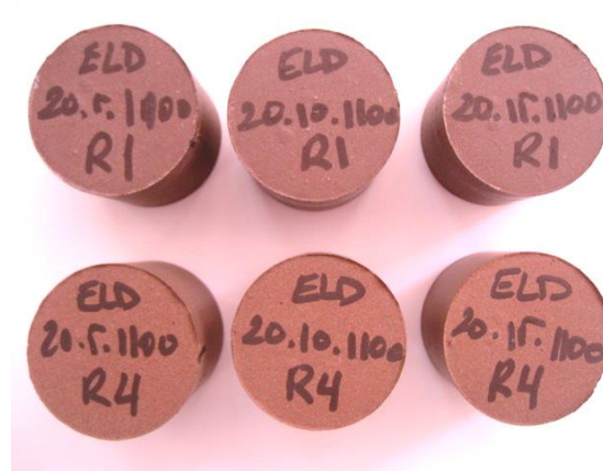
Figura 73. Piezas con el 20% ELD y cocidas a 1100 °C, en la parte superior, correspondientes a todas las presiones de conformado después del ensayo de eflorescencias y en la fila inferior piezas patrón.
