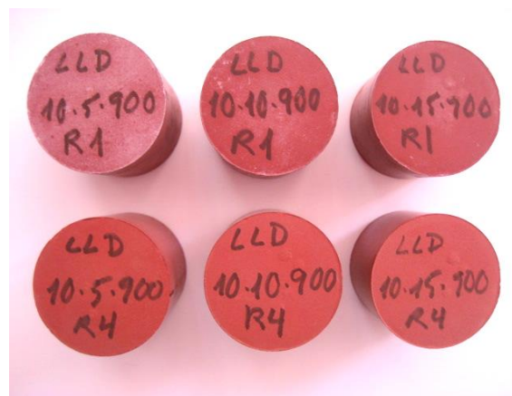
Figura 81. Piezas con el 10% LLD y cocidas a 900 °C, en la parte superior, correspondientes a todas las presiones de conformado después del ensayo de eflorescencias y en la fila inferior piezas patrón.
