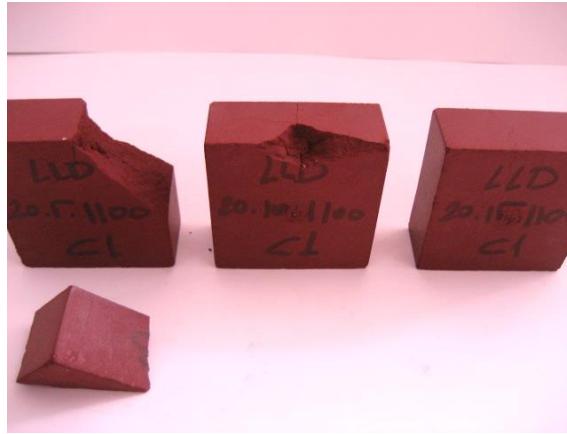
Figura 61. Piezas con el 20% LLD y cocidas a 1100 °C, correspondientes a todas las presiones de conformado después del ensayo de beladicidad.
