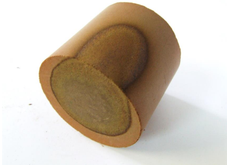
Figura 38. Pieza cilíndrica manchada por corazón negro.
