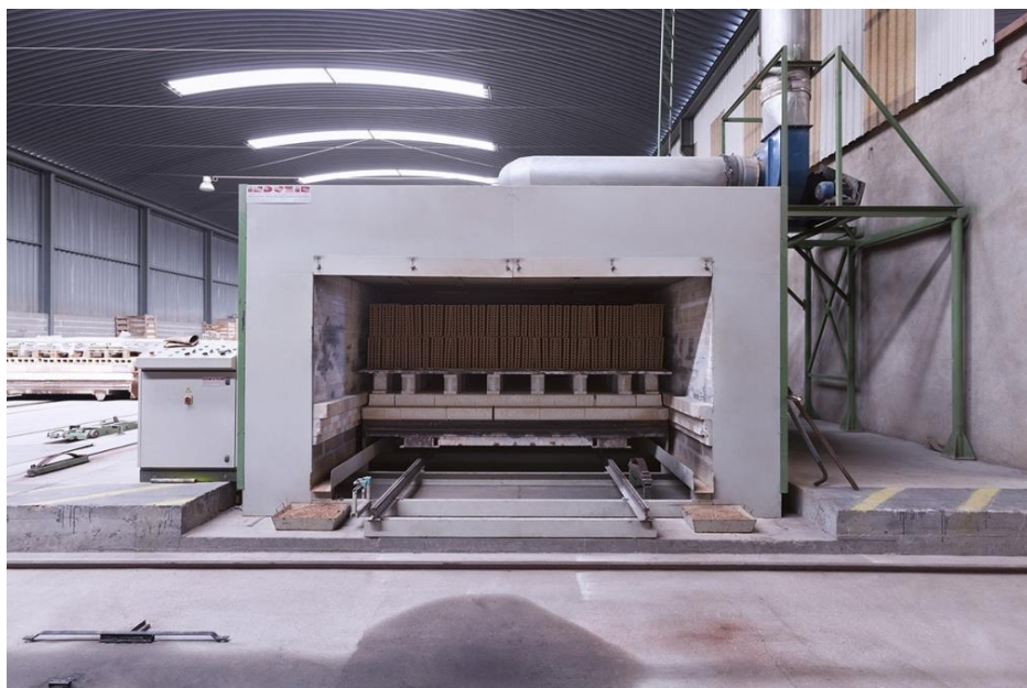
Figura 28. Horno de túnel para la fabricación de ladrillos.
