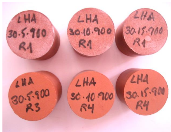
Figura 80. Piezas con el 30% LHA y cocidas a 900 °C, en la parte superior, correspondientes a todas las presiones de conformado después del ensayo de eflorescencias y en la fila inferior piezas patrón.
