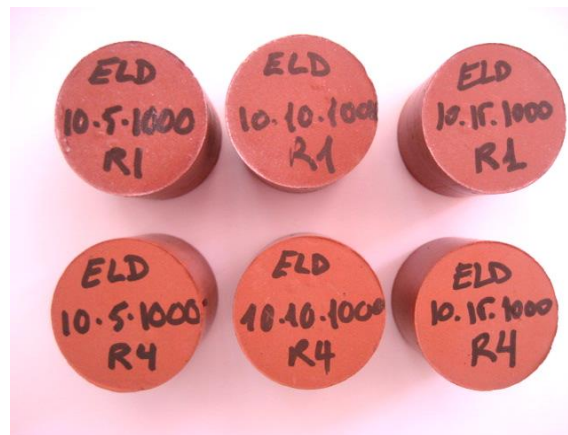
Figura 69. Piezas con el 10% ELD y cocidas a 1000 °C, en la parte superior, correspondientes a todas las presiones de conformado después del ensayo de eflorescencias y en la fila inferior piezas patrón.
