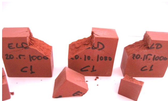
Figura 45. Piezas con el 20% ELD y cocidas a 900 °C, correspondientes a todas las presiones de conformado después del ensayo de beladicidad.
