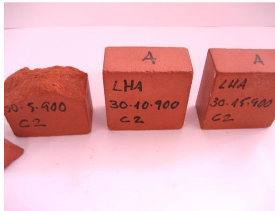
Figura 55. Piezas con el 30% LHA y cocidas a 900 °C, correspondientes a todas las presiones de conformado después del ensayo de heladicidad.
