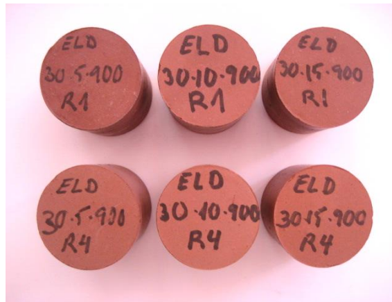
Figura 74. Piezas con el 30% ELD y cocidas a 900 °C, en la parte superior, correspondientes a todas las presiones de conformado después del ensayo de eflorescencias y en la fila inferior piezas patrón.
