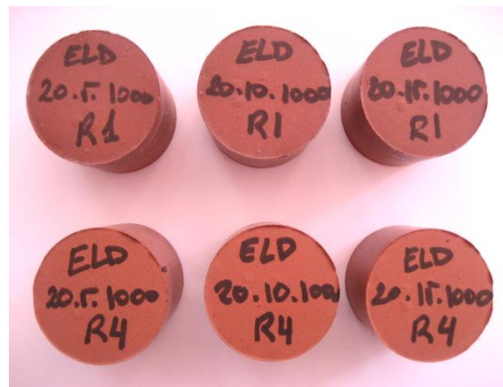
Figura 72. Piezas con el 20% ELD y cocidas a 1000 °C, en la parte superior, correspondientes a todas las presiones de conformado después del ensayo de eflorescencias y en la fila inferior piezas patrón.
