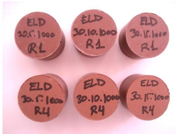
Figura 75. Piezas con el 30% ELD y cocidas a 1000 °C, en la parte superior, correspondientes a todas las presiones de conformado después del ensayo de eflorescencias y en la fila inferior piezas patrón.
