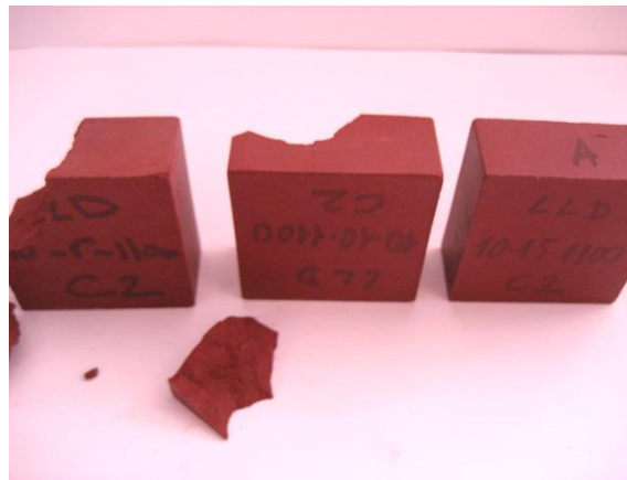
Figura 58. Piezas con el 10% LLD y cocidas a 1100 °C, correspondientes a todas las presiones de conformado después del ensayo de heladicidad.
