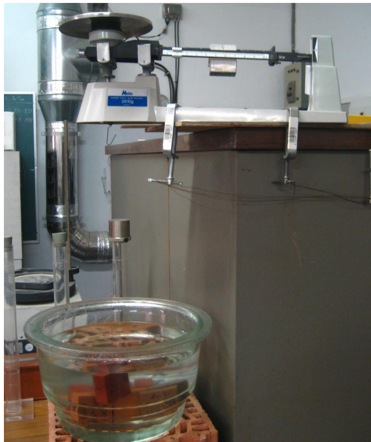
Figura 91. Balanza hidrostática empleada en los ensayos.
