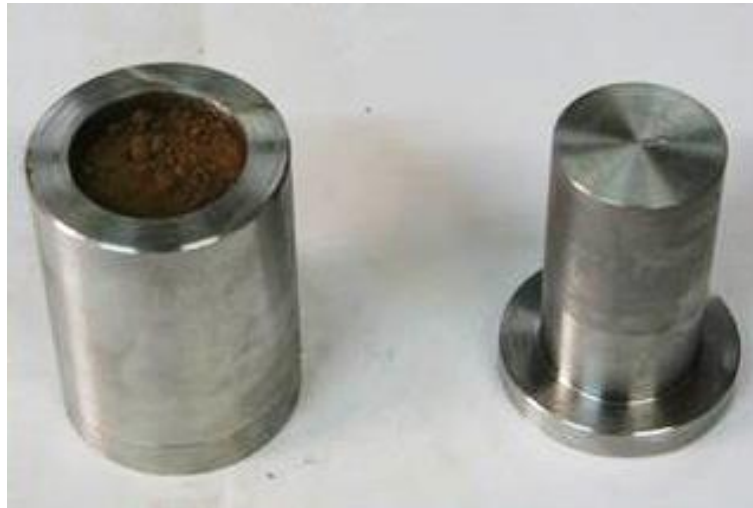
Figura 33. Molde cilíndrico empleado en el proceso de conformado en laboratorio.
