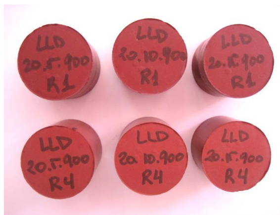
Figura 84. Piezas con el 20% LLD y cocidas a 900 °C, en la parte superior, correspondientes a todas las presiones de conformado después del ensayo de eflorescencias y en la fila inferior piezas patrón.
