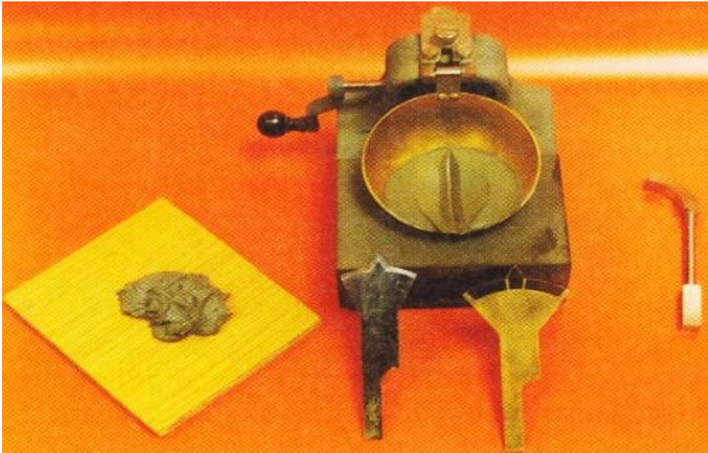
Figura 9. Ensayo con la cuchara de Casagrande para determinar el límite líquido (González de Vallejo, Ferrer, Ortuño, & Oteo, 2004).
