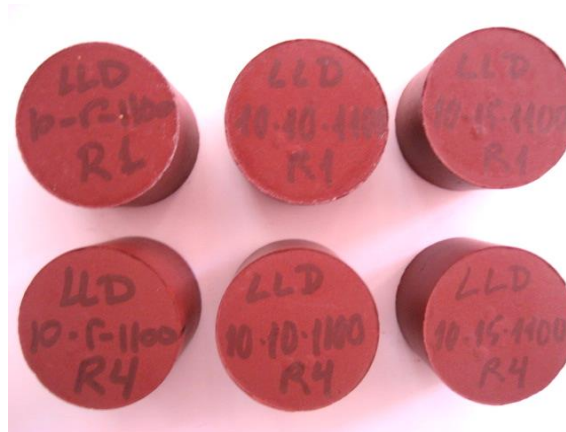
Figura 83. Piezas con el 10% LLD y cocidas a 1100 °C, en la parte superior, correspondientes a todas las presiones de conformado después del ensayo de eflorescencias y en la fila inferior piezas patrón.
