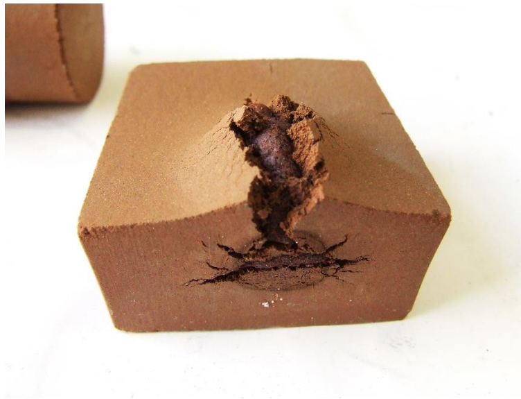
Figura 39. Pieza paralelepípeda rota por corazón negro.
