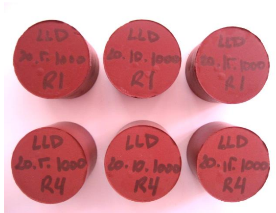
Figura 85. Piezas con el 20% LLD y cocidas a 1000 °C, en la parte superior, correspondientes a todas las presiones de conformado después del ensayo de eflorescencias y en la fila inferior piezas patrón.
