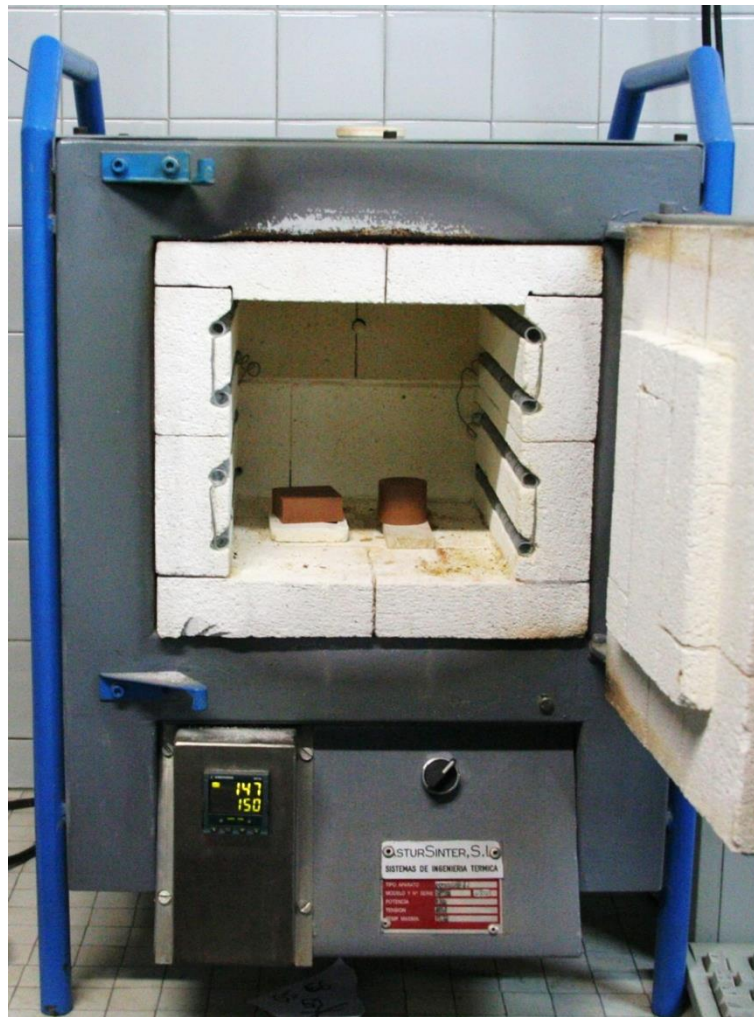
Figura 35. Horno de mufla de la marca Astursinter, utilizado para la cocción de las piezas cerámicas.
