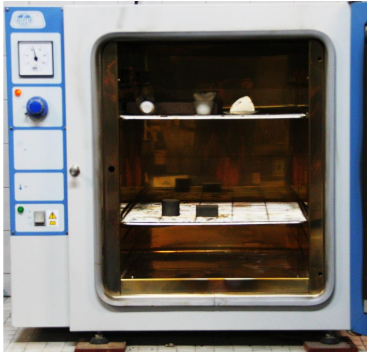
Figura 34. Estufa marca Selecta, utilizada para la etapa de secado.
