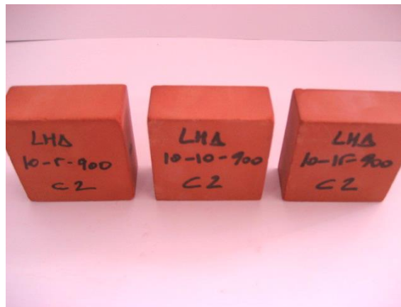
Figura 51. Piezas con el 10% LHA y cocidas a 900 °C, correspondientes a todas las presiones de conformado después del ensayo de heladicidad.
