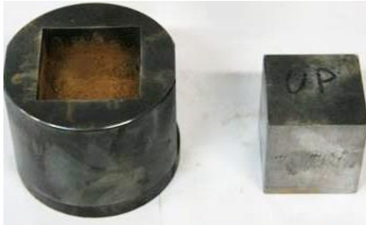
Figura 32. Molde base cuadrada empleado en el proceso de conformado en laboratorio.
