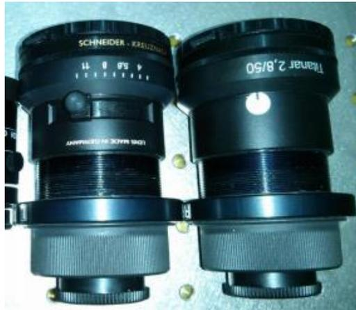
Figura 2. Diferentes lentes utilizadas en el equipo GOM ARAMIS
