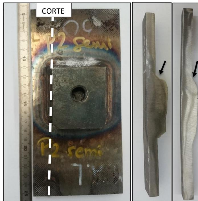
Figura 25. Geometría de las probetas utilizadas en el estudio antes de cortar (izquierda) y después de cortar: probetas MIG (centro) y TIG (derecha)
