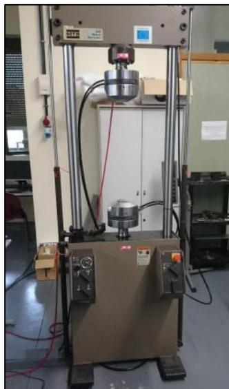
*Figura 26. Máquina de ensayo MTS 810*
