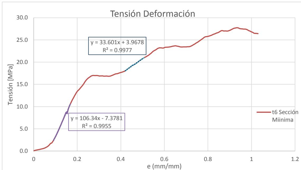
Figura 21. Curva tensión-deformación ingenieril obtenida con valores máquina.
