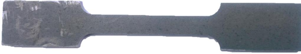
*Figura 4. Geometría de la probeta de tracción utilizada en el ensayo.*
