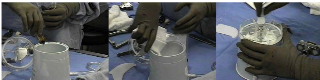
Figura 91 - Mezclado y centrifugado del elemento de cementación
