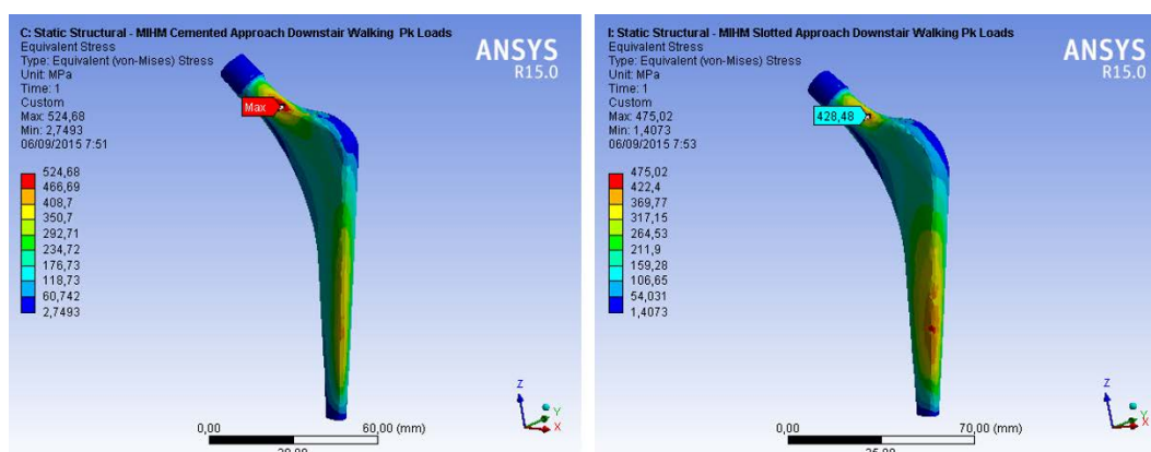
Figura 221 - Evaluación de tensiones equivalentes en puntos comparables del implante.
