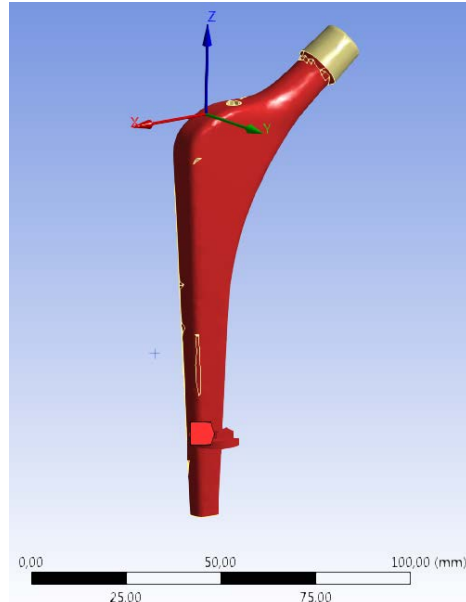
Figura 126 - Superficie de aplicación de pares de rotación
