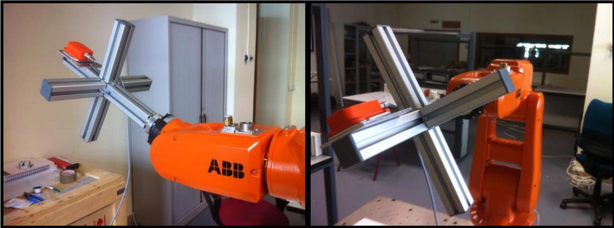
*Figura 4.2: Movimientos de flexión y pronación ejecutados por el robot.*
