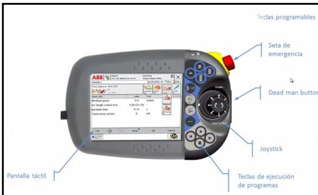
Figura 2.6: Consola de programación portátil o FlexPendant.
