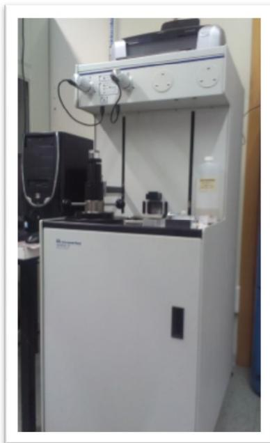
*Figura 13. Porosímetro de intrusión de mercurio*
