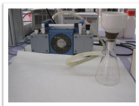
*Figura 16. Matraz kitasato conectado a la bomba de vacío.*
