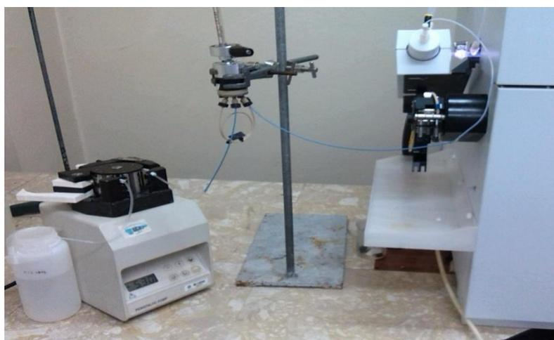
*Figura 5. Sistema FIA-ICP-MS*
