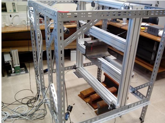
Figura 3: Prototipo de laboratorio, midiendo una sección de carril
