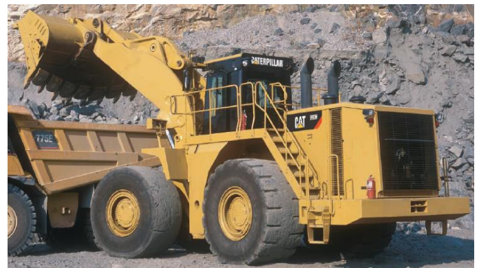
Figura 5. Pala cargadora modelo CAT 990H.
