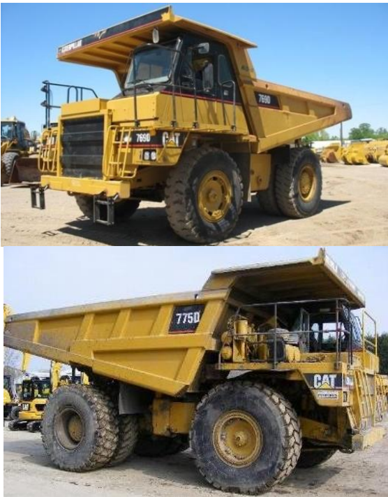
Figura 6. Volquetes Caterpillar modelos 769D y 775D.
