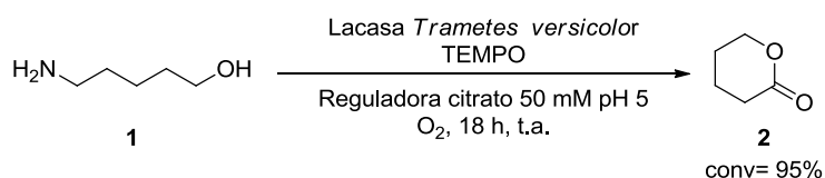
Esquema 18. Tratamiento del aminoalcohol 1 con el sistema formado por la lacasa de Trametes versicolor y el TEMPO, a temperatura ambiente y en una disolución reguladora de citrato a pH 5
