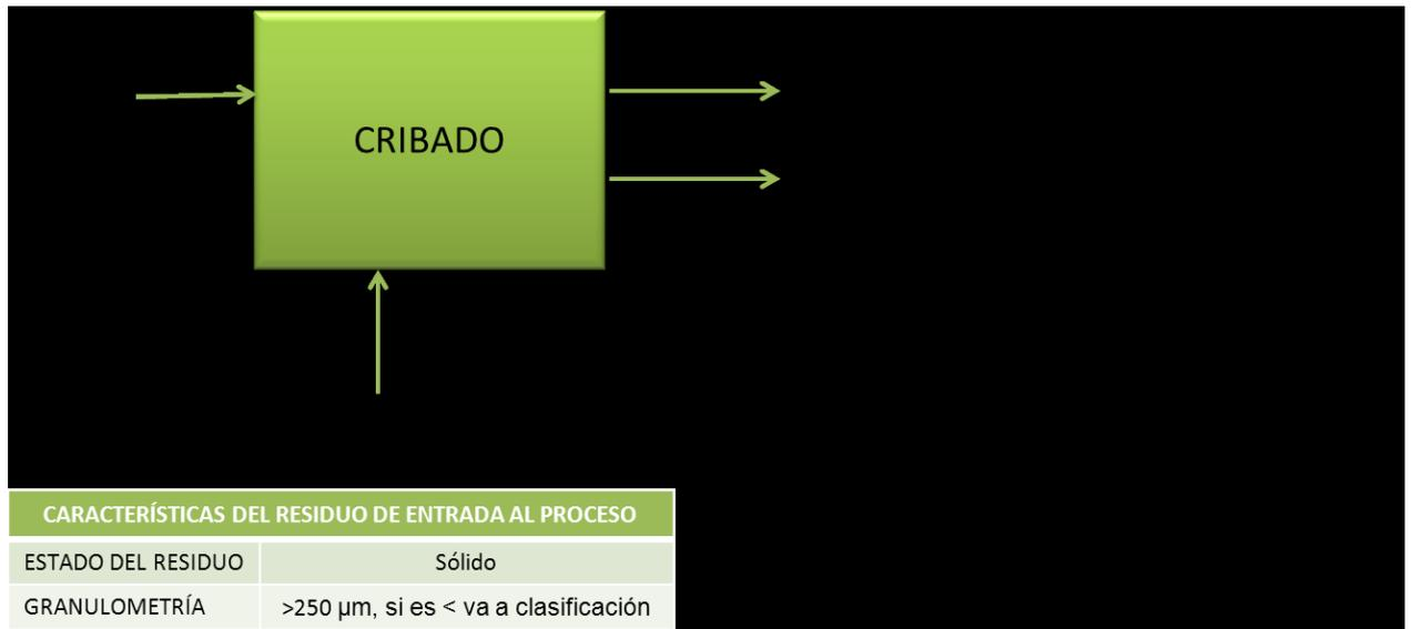
Figura 21: Proceso de cribado y características del RSI a la entrada del proceso
