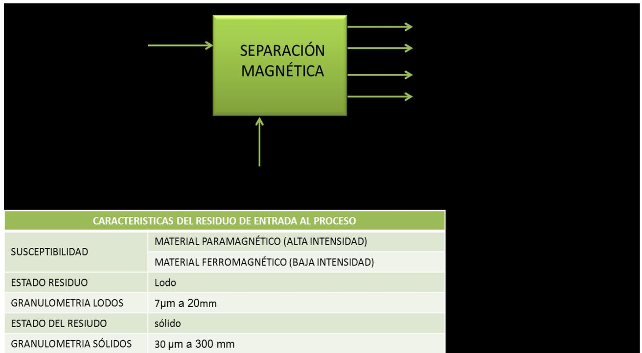
Figura 18: Proceso de separación magnética y características del RSI a la entrada del proceso.
