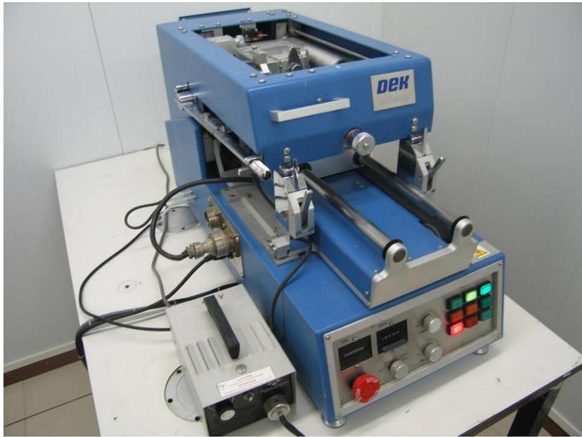
Figura 3.1: Máquina de serigrafiado DEK 1202
