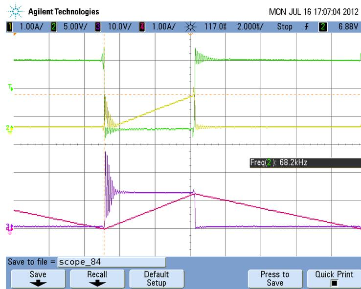
Figura 6.24: Tensiones y corrientes en MOSFETs y bobina sin *snubber*
