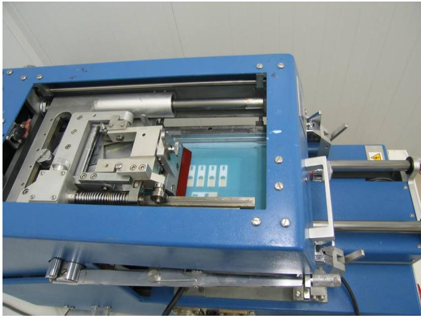
Figura 3.2: Rasqueta de plástico depositando pasta sobre sustrato
