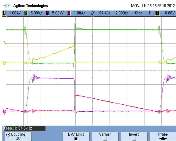
Figura 6.28: Tensiones y corrientes en los MOSFETs con ZVS
