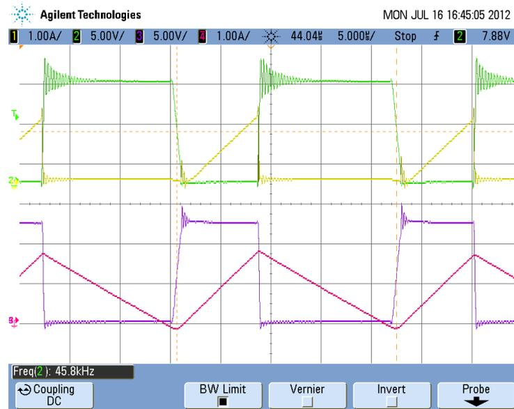
Figura 6.27: Tensiones y corrientes en MOSFETs con 8 nF en paralelo y bobina
