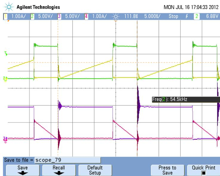
Figura 6.22: Tensiones y corrientes en los MOSFETs sin *snubber*
